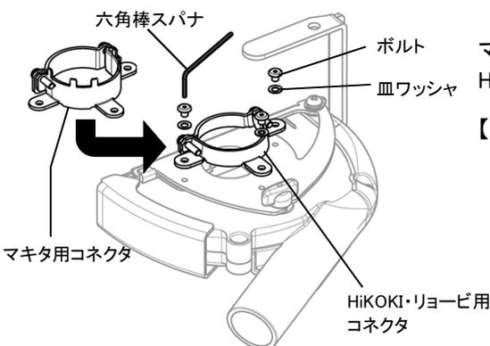
マキタ製ディスクグラインダをお使いの場合は、出荷時に装着されているHiKOKI・リョービ用コネクタを、本体に付属のマキタ用コネクタに交換して下さい。
